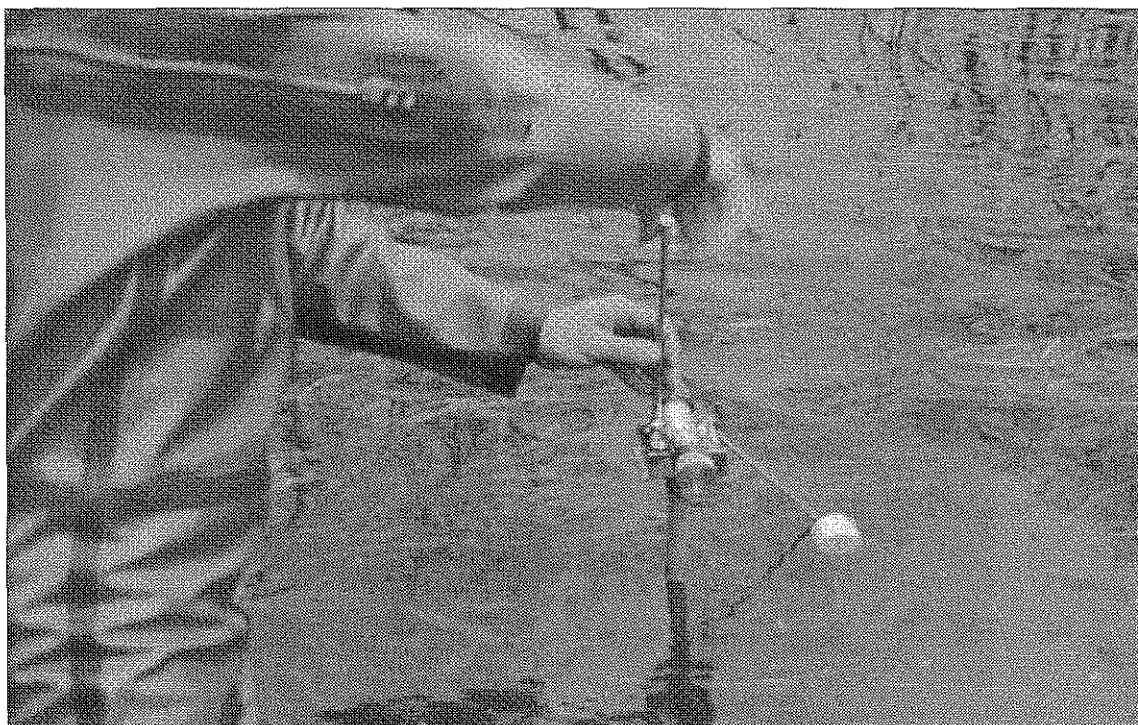
▲ Foto 4 Misuratore di livello a leva installato presso il Lago di Pietrarossa.
