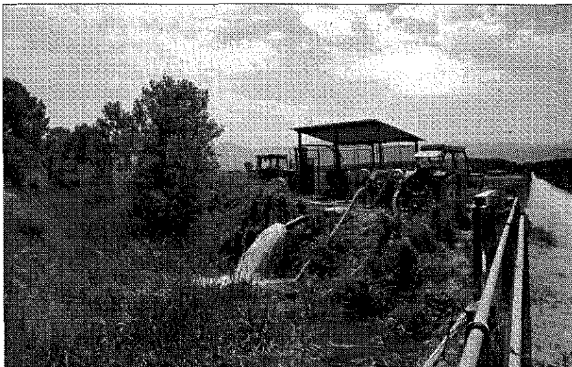
◀ Foto 1 Le acque per l'irrigazione, in buona parte, vengono prelevate dai canali di raccolta con l'ausilio di pompe azionate dai motori dei mezzi agricoli. (foto Burri - prop. ARSSA)
